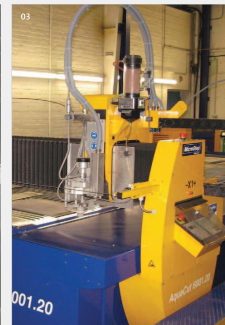
01 Découpe de moule / 02 Découpe de haute précision avec un rotateur à jet d'eau / 03 Découpe en 2D par jet d'eau avec un AquaCut 6001.20
