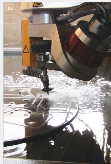
01 Découpe de moule / 02 Découpe de haute précision avec un rotateur à jet d'eau / 03 Découpe en 2D par jet d'eau avec un AquaCut 6001.20
